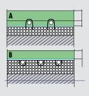
NE 425 è indicata per l'applicazione sopra impianti di riscaldamento a pavimento ribassati (in ancoraggio al solaio) con 10-15 mm sopra l'impianto.
